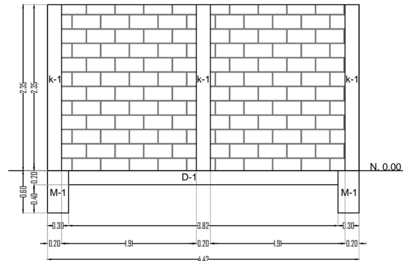
BARDA DE BLOCK MACIZO DE 12X20X40 CM ASENTADO CON MORTERO DE JUNTEO Y REFUERZOS DE CASTILLOS A DISTANCIA INDICADA ACABADO INICIAL REPELLADO FINO Y ACABADO FINAL PINTURA VINILICA .
