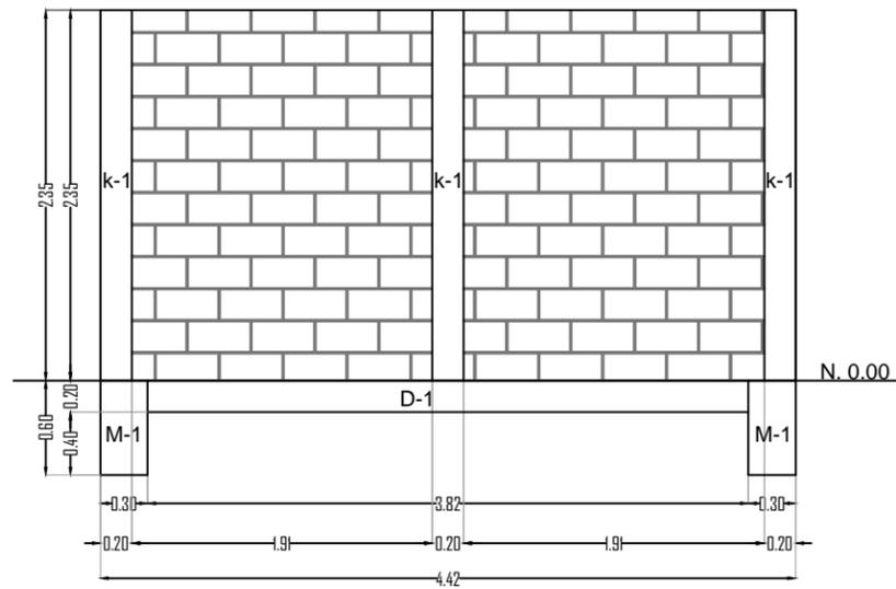
BARDA DE BLOCK MACIZO DE 12X20X40 CM ASENTADO CON MORTERO DE JUNTEO Y REFUERZOS DE CASTILLOS A DISTANCIA INDICADA ACABADO INICIAL REPELLADO FINO Y ACABADO FINAL PINTURA VINILICA .
